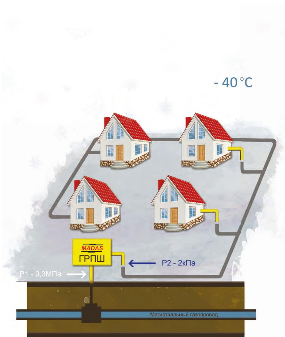
Работа регулятора при температуре -40°C
